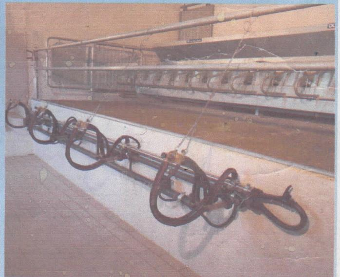
▶ Sala di mungitura 12 in linea: 4 gruppi trasporto latte e pulsazione elettronica. Capacità: più di 100 capi/h con 1 operatore.
