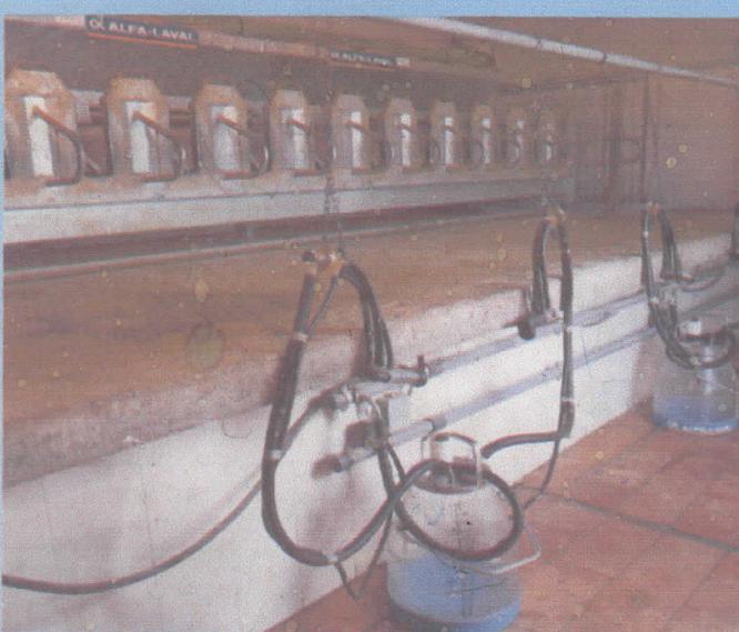
◀ Sala di mungitura 12 in linea: 4 gruppi/2 secchi con pulsazione elettronica. Capacità: più di 90 capi/h con 1 operatore.
